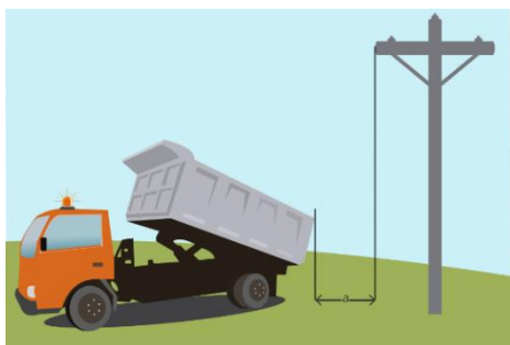
Rysunek 1 Odległości (a) od linii napowietrznych w zależności od napięcia
