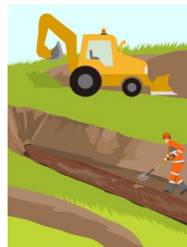
Rysunek 2 Ręczne wykopy w miejscach możliwych zbliżeń do sieci
